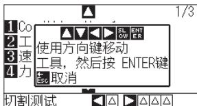
确认测试切割的结果，调整速度/切割压/加速度，使其处于最佳设定。如果是普通的裁片用纸，底纸上会留下淡淡的切痕。此外，请确认三角形、四角形的角，调整偏移量，实现良好的角切割。
