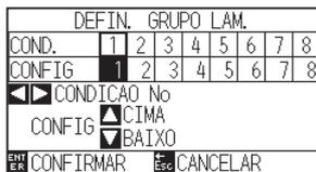
**9** Pressione a tecla de POSITION (◀▶) para selecionar o n° da condição da ferramenta (N° DE CONDIÇÃO).
