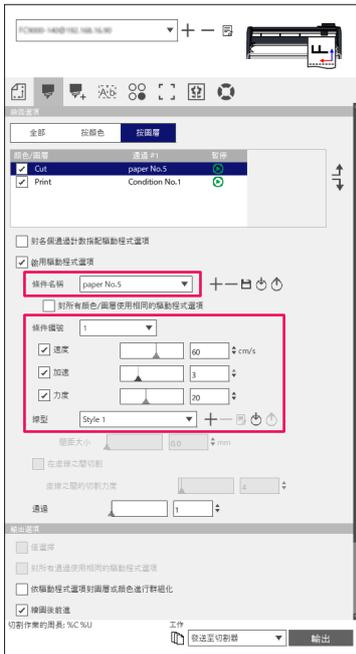
5. 在“條件編號”中指定切割繪圖機主體所使用的條件編號。
