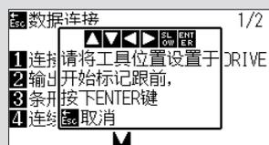
3. 按下切割繪圖機的POSITION (▲▼◀▶) 鍵，將工具中心移至條碼旁的開始標記（參照下圖）的跟前。
