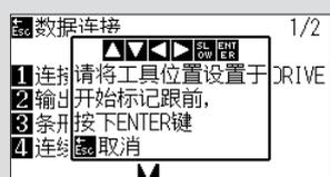
3. 按下切割绘图仪的POSITION (▲▼◀▶) 键, 将工具中心移至条形码旁的开始标记 (参照下图) 的跟前。
