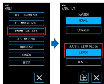
3. Toque em (Sair) para voltar à tela “HOME” e insira o material impresso para realizar um corte de amostra.
