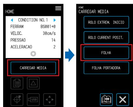
5. Posicione a extremidade da mídia de folha contra os roletos. Passe a mídia de folha por baixo da guia de posicionamento do rolo e carregue-a de modo a ficar paralela à guia dianteira.
