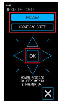
Os padrões de teste de corte serão criados usando valores de definição aumentados/diminuídos na ordem de corte mostrada à direita.
